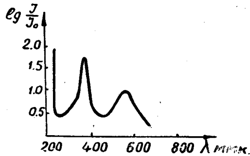
Рис. 4. Спектр поглощения при облучении кристаллов \text{CaF}_2 , до окрашивания содержащих полосы в ультрафиолетовой области спектра [15]
