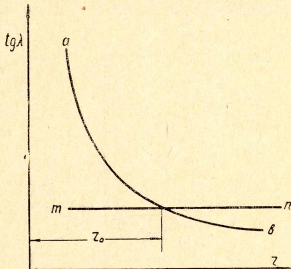
Рис. 1. График изменения тангенса угла подъема винтовой линии в зависимости от изменения радиуса цилиндрического сечения:  $ab$  — кривая изменения тангенса угла подъема у винтовой линии;  $mn$  — у плоскости
