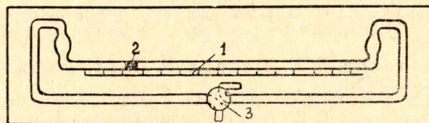
Рис. 2. Газовая бюретка: 1 — ртутный затвор; 2 — четырехходовой кран
