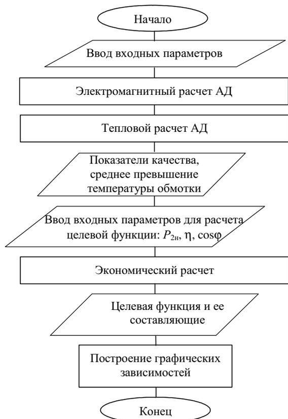
**Рис. 2.** Структурная схема математического моделирования оценки экономической эффективности при проектировании и изготовлении АД
