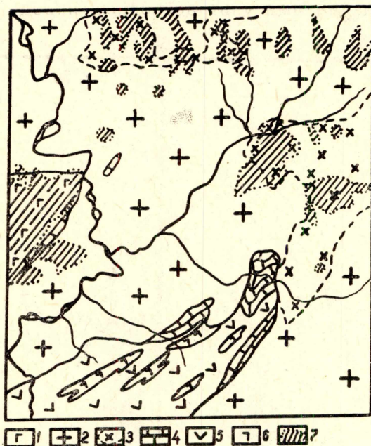
Рис. 4. Схематическая геологическая карта района горы Изых. 1 — габброиды горы Изых; 2 — гранитоиды Улень-Туимского плутона; 3 — гибридные породы Улень-Туимского плутона; 4 — карбонатные породы каратгской толщи; 5 — амфиболитизированные диабазы каратгской толщи; 6 — тела габбро-диоритов и габбро-диабазов габбро-диорит-диабазовой формации; 7 — ореолы повышенного содержания Ni и Cr по результатам металлометрического опробования
