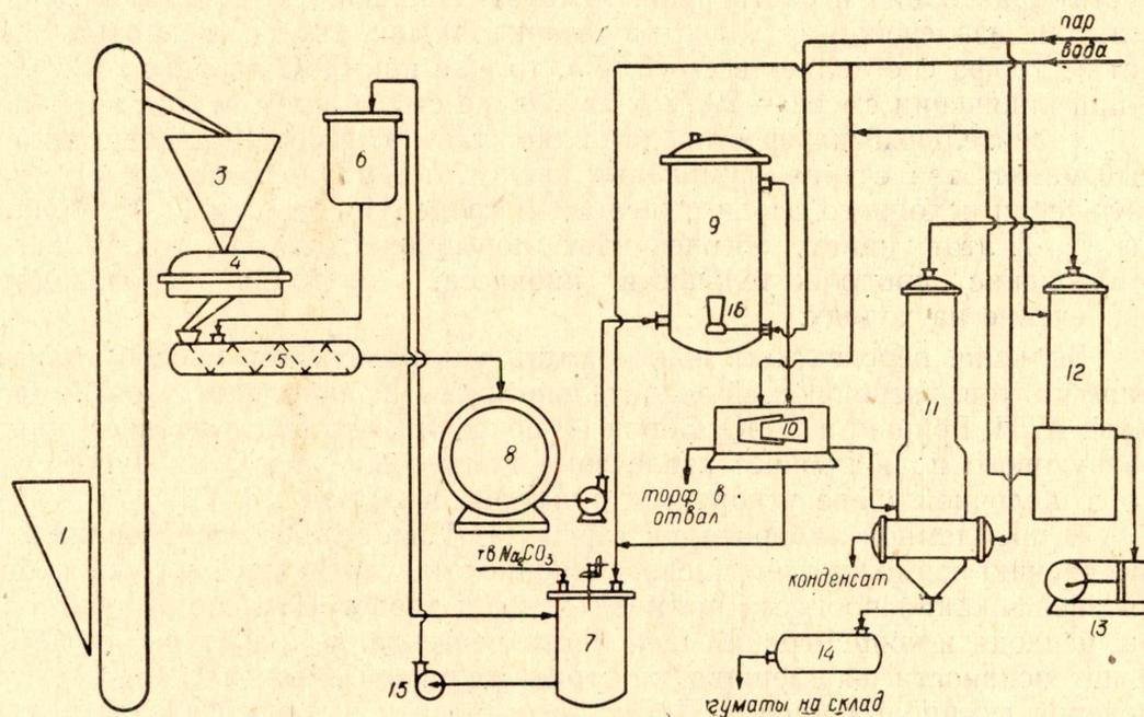
Рис. 1. Технологическая схема получения гуматов натрия: 1 — бункер для сырья, 2 — элеватор, 3 — промежуточный бункер, 4 — молотковая дробилка, 5 — шнек-смеситель, 6 — емкость для раствора, 7 — сборник, 8 — механический диспергатор, 9 — реактор, 10 — осадительная центрифуга, 11 — выпарной аппарат, 12 — поверхностный конденсатор, 13 — вакуумнасос, 14 — сборник гуматов, 15 — насос, 16 — эжектор
