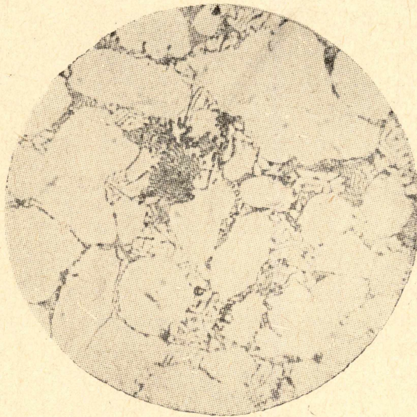
Рис. 5. Микроструктура литой стали P18 с 1,3% C; \times 600 (травитель: 10 г K_3(CN)_6 , 10 г KOH на 100 мл воды)
