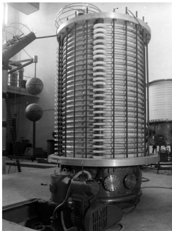
Рис. 1. Корпус электронной пушки на 3 МВ с секционированной полиэтиленовой изоляцией и принудительным выравниваем распределения напряжения
