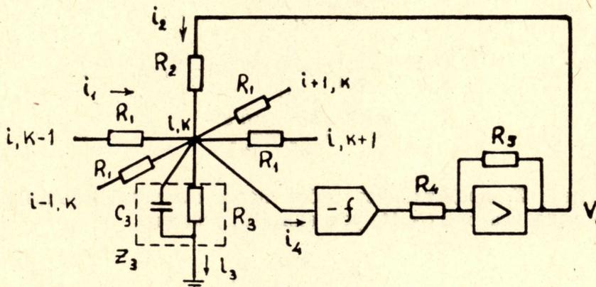
Рис. 1. Ячейка активной сеточной модели
