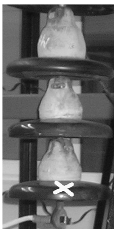
Рис. 3. Локация звука, зарегистрированная Ultraprobe на расстоянии 1 м. Максимальная интенсивность звука зафиксирована на частоте в районе 30 кГц (белый крест указывает место локализации источника звука ЧР)
