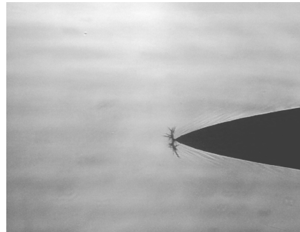
Рис. 3. Оптические картины начальной стадии зарождения дендритов в ПММА при преобладании: а) V_{\parallel} и б) V_{\perp} . U=25 кВ; r=5 мкм; d=15 мм; h=5 мм
