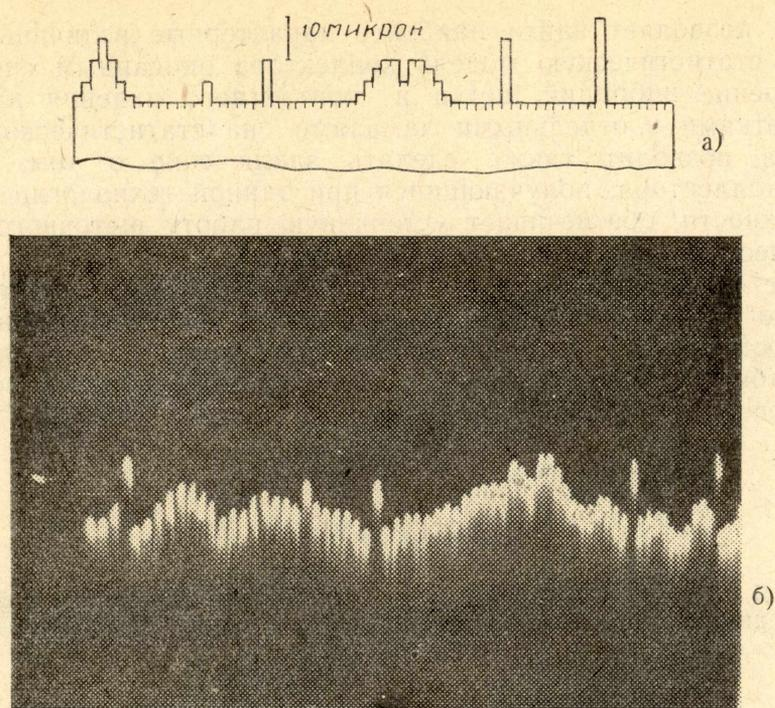
Рис. 2. а — запланированный профиль коллектора, б — реализованный профиль
