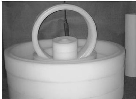
Рис. 2. Крупногабаритные изделия из ПЭНП диаметром: а) 3 м и б) до 1,5 м
