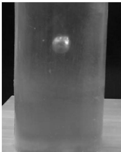
Рис. 9. Образование газового пузыря в заготовке из ПК
