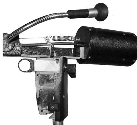
Рис. 3. Фотография корпусной конструкции пистолетного типа волоконно-оптических эндоскопов "КОБРА" и "ГРАДАН" с установленным УОУ (верхняя крышка корпуса снята, в нижней выполнен вырез, рукоятка открыта)
