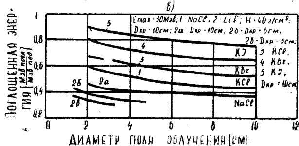
Рис. 1. Распределение поглощенной энергии по объему образцов щелочногалогидных кристаллов при облучении тормозным излучением различной энергии.
