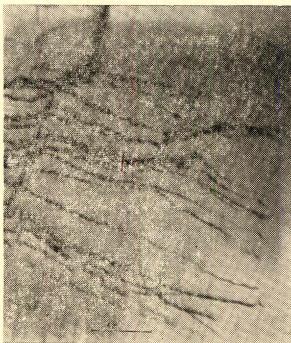
Рис. 6. Структуры полиэтилена быстрого охлаждения ( а ) и медленного охлаждения ( б ), полученные с угольных реплик, оттененных хромом
