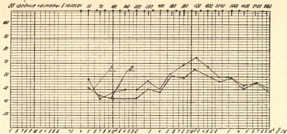
Рис. 3. Спектрограммы воздушного шума электродвигателя АО2-21-2 при  $U=380$  в, с. д. — Y,  $f=50$  гц. 1 — с вентилятором основного исполнения (3 лопатки), 2 — с вентилятором тарельчатого типа (8 лопаток)
