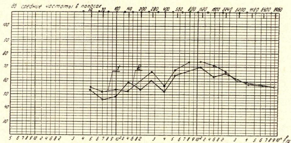
Рис. 1. Спектрограммы воздушного шума электродвигателя АО2-42-2 при  $U=380$  в, с. ф. — Y,  $f=50$  гц. 1 — с вентилятором основного исполнения (3 лопатки), 2 — с вентилятором тарельчатого типа (8 лопаток)
