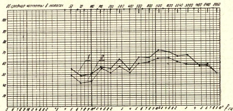
Рис. 2. Спектрограммы воздушного шума электродвигателя АО2-32-2 при  $U=380$  в, с. ф. — Y,  $f=50$  гц. 1 — с вентилятором основного исполнения (3 лопатки), 2 — с вентилятором тарельчатого типа (6 лопаток)
