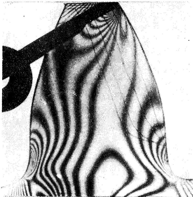
Рис. 2. Нагруженный новый зуб колеса из оптически активного материала в поляризованном свете.
