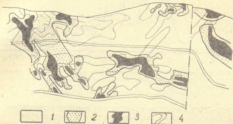
Рис. 1. План изолиний содержания золота и мощности жилы Николаевской-2 (проекция на горизонтальную плоскость). Содержание золота: 1—низкое, 2—среднее, 3—высокое; 4—изолинии мощности через 1 м
