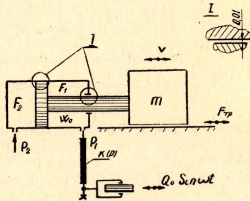
Рис. 1. Схема экспериментальной установки для изучения динамических процессов
