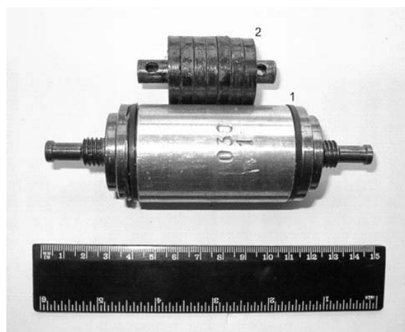
Рис. 1. Схема устройства магнитоактиватора МАЖ: 1) корпус, 2) магнитная система
