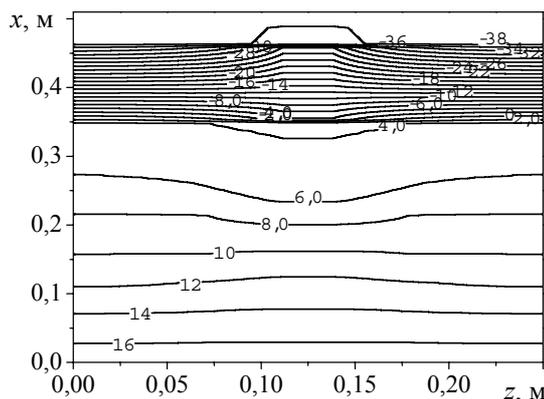
Рис. 2. Изотермы в поперечном сечении фрагмента  $y=Y_k/2=0,125$  м, проходящем через ось коннектора при  $\tau=170$  ч;  $t, °C$
