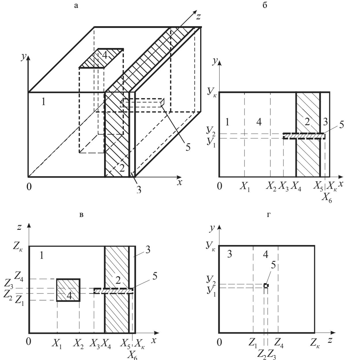
**Рис. 1.** Схема неоднородного фрагмента керамзитобетонной стены: 1) керамзитобетон; 2) утеплитель фасадной системы утепления; 3) обшивка; 4) внутренний утеплитель; 5) коннектор; а) общий вид фрагмента; б-г) виды фрагмента сбоку (б, г) и сверху (в)
