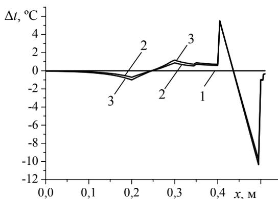
Рис. 3. Перепад температур  $\Delta t=t(x, Y_k/2, Z_k)-t(x, Y_k/2, Z_k/2)$  по толщине утепленного фрагмента в различные моменты времени  $\tau$ : 1) 0; 2) 2,5; 3) 170 ч
