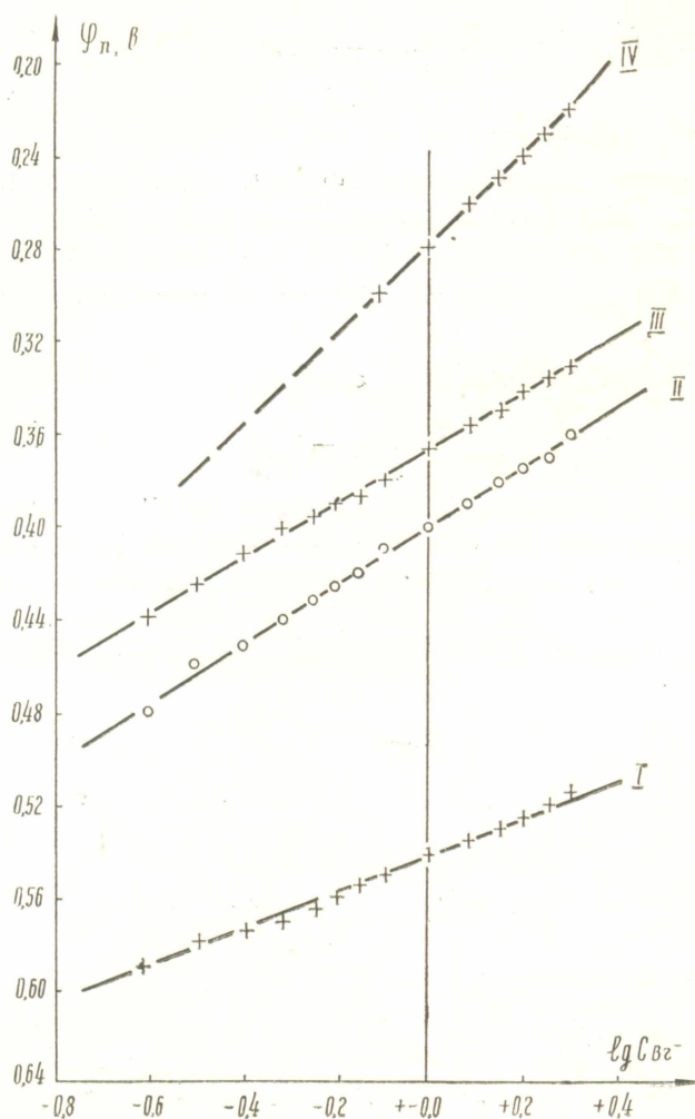
Рис. 4. Зависимость потенциалов пиков золота от логарифма концентрации бром-ионов. Пояснения в тексте.
