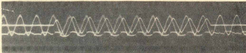
Рис. 2. Оциллограмма процесса импульсно-дуговой сварки на переменном токе
