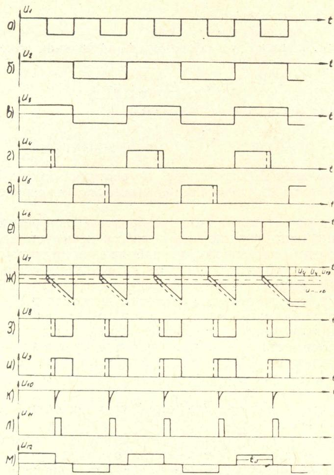
Рис. 2. Временные диаграммы схемы управления инвертором.
