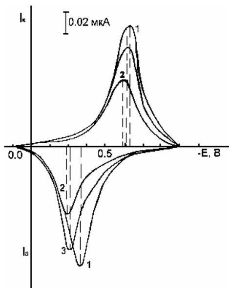
**Рис. 3.** Циклические вольтамперограммы свинца на фоне 0,1 М КВr,  $E_{н} = -0,1$  В: 1)  $C_{ПАВ} = 0$ ,  $\Delta E_{ка} = 0,35 \pm 0,01$  В,  $I_{к}/I_{а} = 1,20$ ; 2)  $C_{ПАВ} = 0,40$  ммоль/л,  $\Delta E_{ка} = 0,26 \pm 0,01$  В,  $I_{к}/I_{а} = 0,68$ ; 3)  $C_{ПАВ} = 0,40$  ммоль/л,  $f = 150$  МГц,  $\Delta E_{ка} = 0,29 \pm 0,01$  В,  $I_{к}/I_{а} = 1,0$
