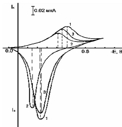
Рис. 1. Циклические вольтамперограммы свинца на фоне 0,1 М KF при  $E_{н} = -0,1$  В: 1)  $C_{ТБА} = 0$ ,  $\Delta E_{ка} = 0,18 \pm 0,01$  В,  $I_k/I_a = 0,24$ ; 2)  $C_{ТБА} = 0,40$  ммоль/л,  $\Delta E_{ка} = 0,14 \pm 0,01$  В,  $I_k/I_a = 0,18$ ; 3)  $C_{ТБА} = 0,40$  ммоль/л,  $f = 150$  МГц,  $\Delta E_{ка} = 0,18 \pm 0,01$  В,  $I_k/I_a = 0,25$
