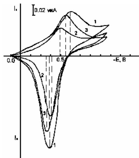
Рис. 2. Циклические вольтамперограммы свинца на фоне 0,1 М KCl,  $E_{н} = -0,1$  В: 1)  $C_{ТБА} = 0$ ,  $\Delta E_{ка} = 0,17 \pm 0,01$  В,  $I_k/I_a = 0,28$ ; 2)  $C_{ТБА} = 0,40$  ммоль/л,  $\Delta E_{ка} = 0,12 \pm 0,01$  В,  $I_k/I_a = 0,23$ ; 3)  $C_{ТБА} = 0,40$  ммоль/л,  $f = 150$  МГц,  $\Delta E_{ка} = 0,17 \pm 0,01$  В,  $I_k/I_a = 0,29$
