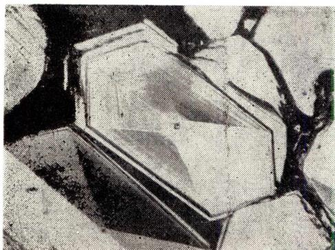
Рис. 1. Формы роста кристаллов феррита иттрия в поверхностной пленке расплава при содержании в исходном составе растворителя фтористого свинца 50% мол. Ув. 20<sup>x</sup>
