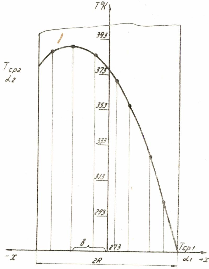
Рис. 1. Стационарная теплопроводность в пластине при внутреннем тепловыделении.
