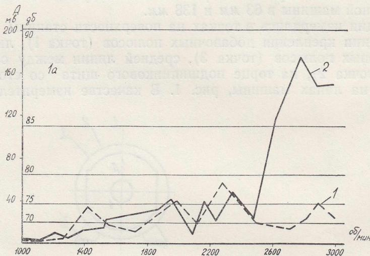
Рис. 2. Виброграммы участков станины, соответствующих точкам 1 и 2: 1 — скос зубцов «елочкой», 2 — линейный скос
