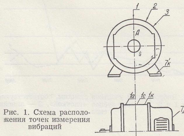
боров использовались виброметр SM-211 с датчиком КД-13 и анализатор спектра частот «Marconi». Измерения уровня вибраций производились при плавном изменении скорости вращения якоря от 1000 об/мин
