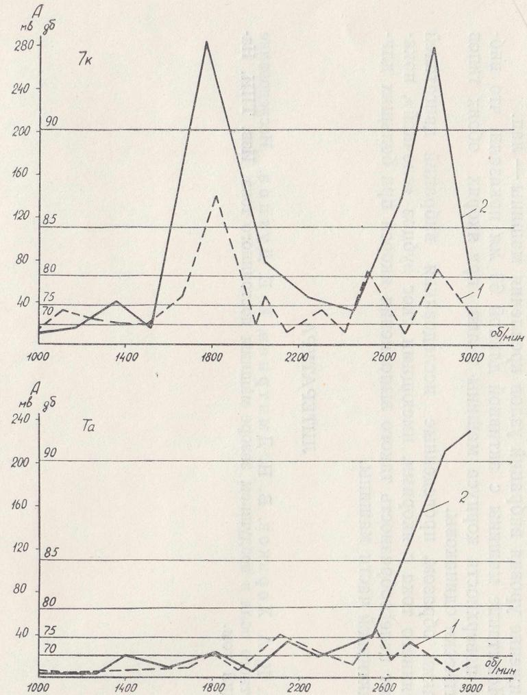
Рис. 4. Виброграммы лап и подшипникового щита: 1 — скос зубцов «елочкой», 2 — линейный скос
