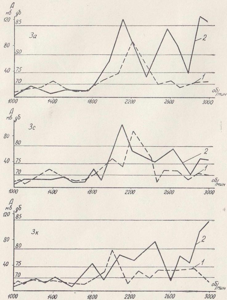
Рис. 3. Виброграммы участков, расположенных по длине станины по линии главных полюсов: 1 — скос зубцов «елочкой», 2 — линейный скос
