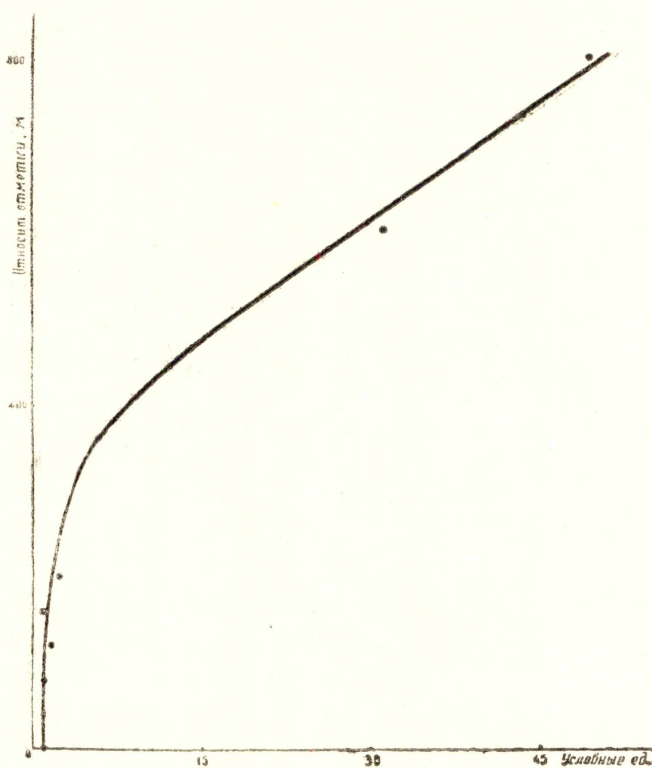
Рис. 2. Изменение радиоактивности акцессорного сфена (в условных единицах) из гранита четвертой интрузивной фазы в вертикальном разрезе Элекмонарского массива.
