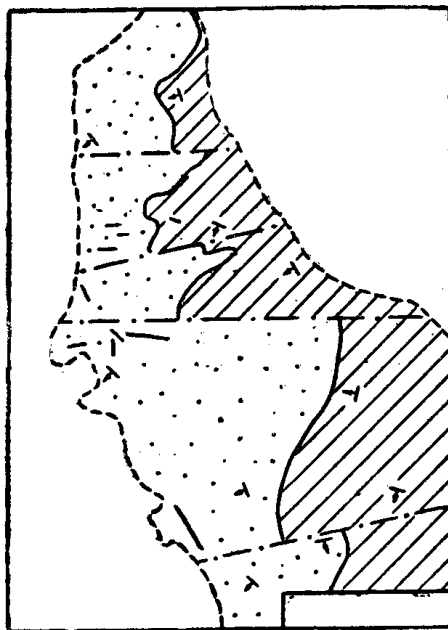
Рис. 3. Схема геологического строения участка центральной залежи Восточно-Кемпирсайского месторождения: 1 — гипербазиты и их кора выветривания; 2 — габброиды и их кора выветривания; 3 — дайки габбро-диабазов; 4 — дизъюнктивы; 5 — контуры заснятого участка.
