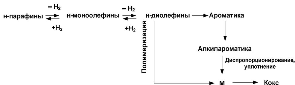
Рис. 1. Схема образования мономера уплотнения M в процессе получения n-моноолефинов
