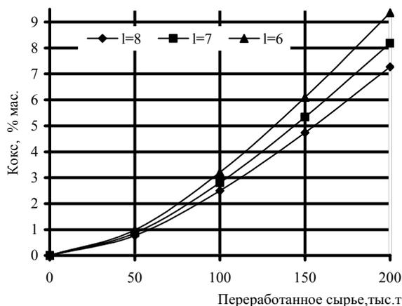
Рис. 2. Зависимость образования кокса на катализаторе от объема переработанного сырья и мольного соотношения *I* – «водород:сырье»
