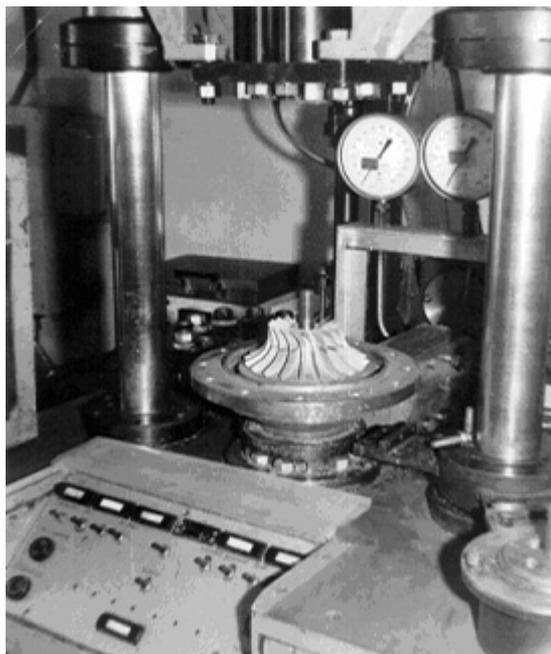
Рис. 2. Абразивно-экструзионная обработка крыльчатки на установке УЭШ-100
