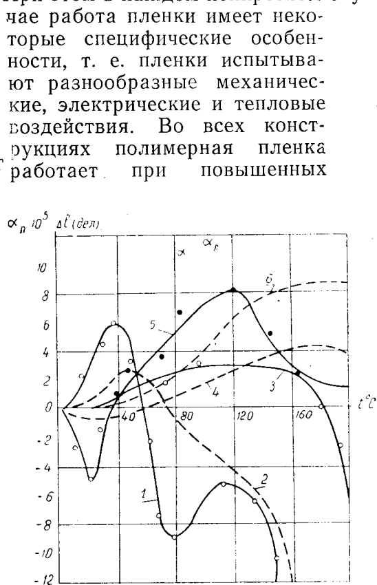
Рис. 2. Изменение \Delta l и \alpha_l в зависимости от температуры полиэтилентерефталата (в продольном направлении): 1 — \alpha_l ; 2 — \Delta l — исходное состояние; 3 — \alpha_l ; 4 — \Delta l — после 24 часов старения при 140^\circ\text{C} ; 5 — \alpha_l ; 6 — \Delta l — после 240 часов старения при 140^\circ\text{C}
