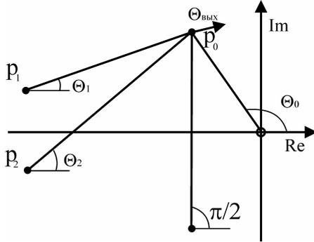
Рис. 1. Расположение полюсов и нулей при  $m=2$
