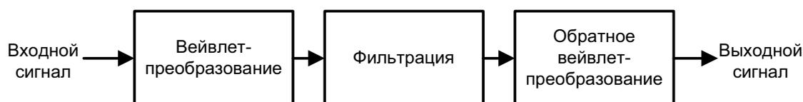
Рис. 2. Обобщенная схема фильтрации
