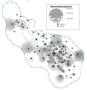
Рис. 3. Накопленные отборы нефти и воды
