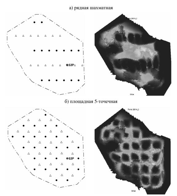
Рис. 1. Распределение плотности остаточных запасов для трех схем разработки
