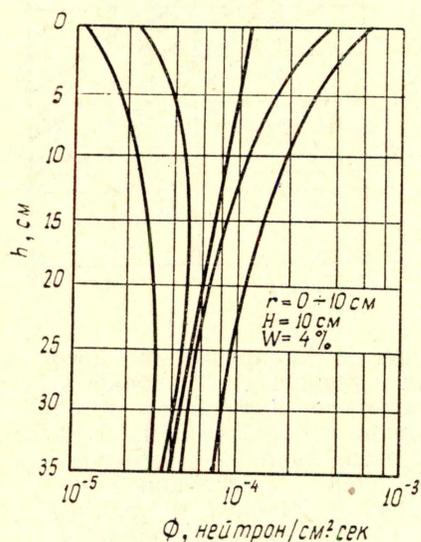
Рис. 5. Влияние размеров отражателя на распределение потока тепловых нейтронов по глубине. Цифры у кривых, диаметр и толщина цилиндрического отражателя: 1 —  $20 \times 7,5$ , 2 —  $15 \times 5$ , 3 —  $20 \times 3$ , 4 —  $20 \times 7,5 + \text{Cd}$ , 5 — без отражателя.
