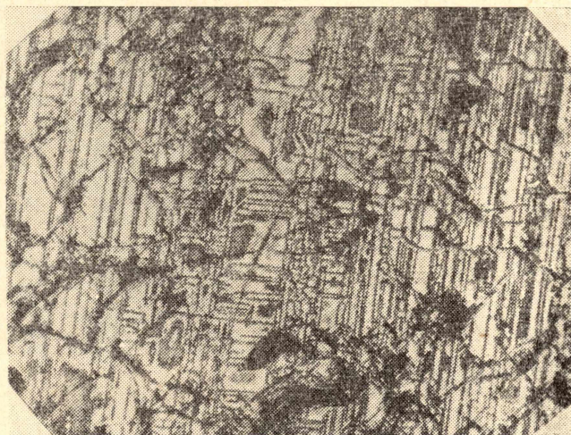
Рис. 5б. Деталь. Параллелепипедальные блоки в кристалле магнетита, имеющие явно прямоугольный характер. Дашкесан. Увел. 400.
