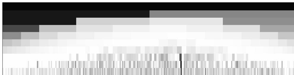
Рис. 1. Результат вейвлет-преобразования кривой остаточного тока
