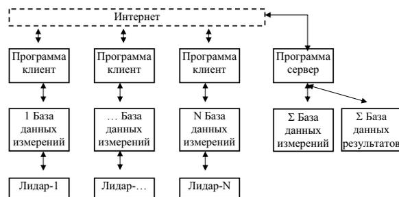
Рис. 2. Структура разрабатываемой распределенной информационной системы
