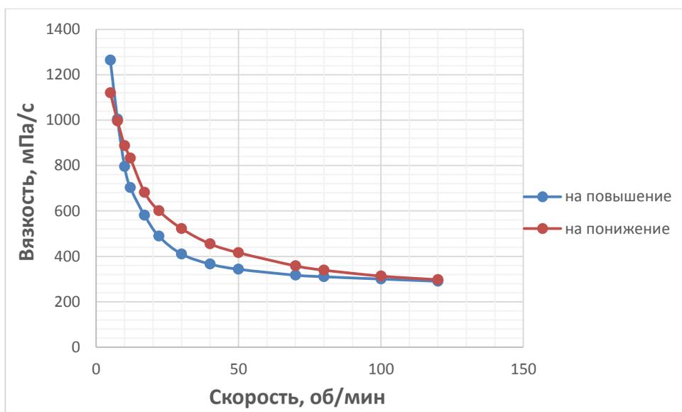
Рис. 2 Динамическая вязкость при помоле в ШБМ 1 час
