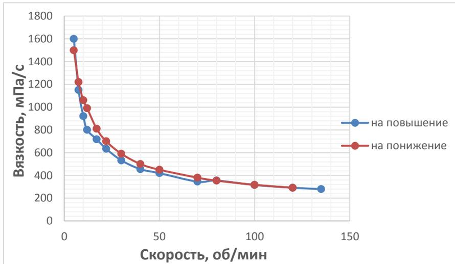
Рис. 4. Динамическая вязкость при помоле в ШБМ 5 час
