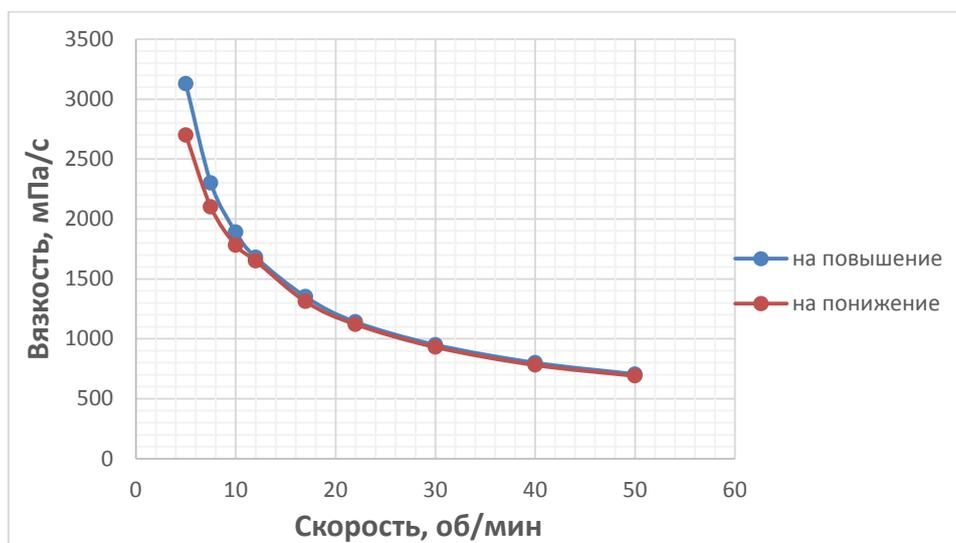
Рис. 6. Динамическая вязкость при помоле в ШБМ 9 часов
