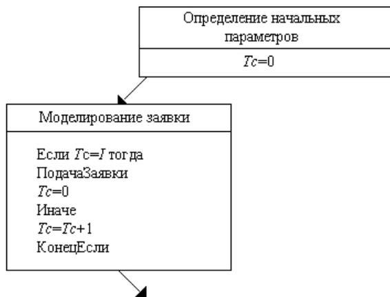
Рис. 2. Алгоритм моделирования заявки для систем с периодической стратегией.  $T_c$  – счетчик,  $I$  – интервал подачи заявок
