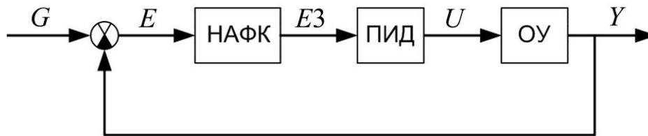
Рис. 1. Структура САР с нечетким адаптивным фазовым корректором
