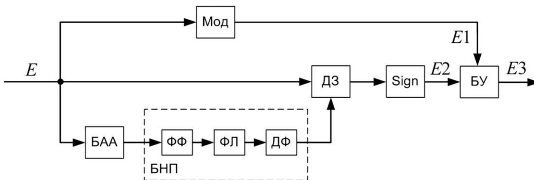
Рис. 2. Структурная схема нечеткого адаптивного фазового корректора
