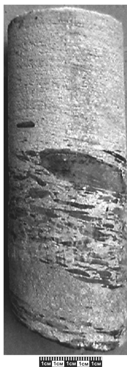
Рис. 2. Песчаник косослоистый с послойными включениями галек глинистых пород. Керн, гл. 3113
