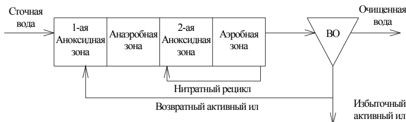
Рис. 7. Принципиальная схема процесса JNB
