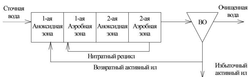
Рис. 5. Принципиальная схема процесса Bardenpho
