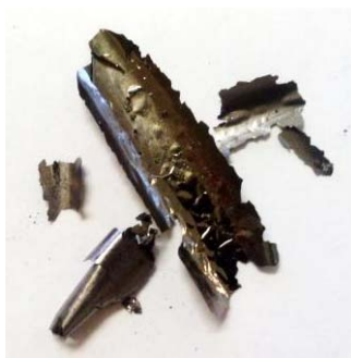
Рис. 2. Образец, полученный лабораторным методом на стенке кварцевой трубки
