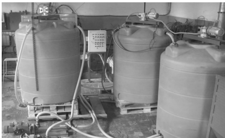
Рис. 1. Экспериментальная установка нитри-денитрификации
