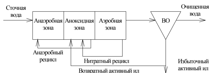
Рис. 3. Принципиальная схема процесса UCT
