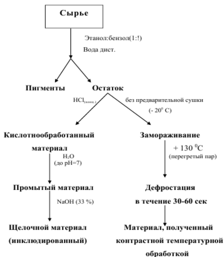
Рис. 1. Способы получения сорбентов на основе лузги подсолнечника и плодовых оболочек гречихи
