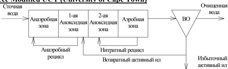
Рис. 5. Принципиальная схема процесса Modified UCT
