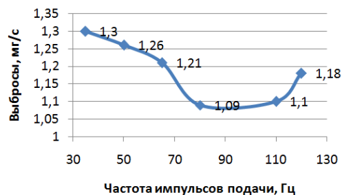
Рис. 2. Зависимость выбросов дыма от частоты импульсов
