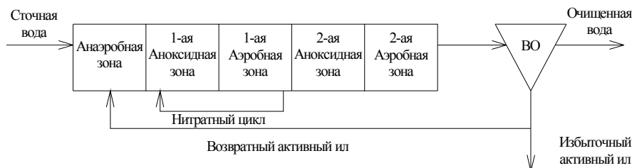
Рис. 6. Принципиальная схема процесса Modified Bardenpho
