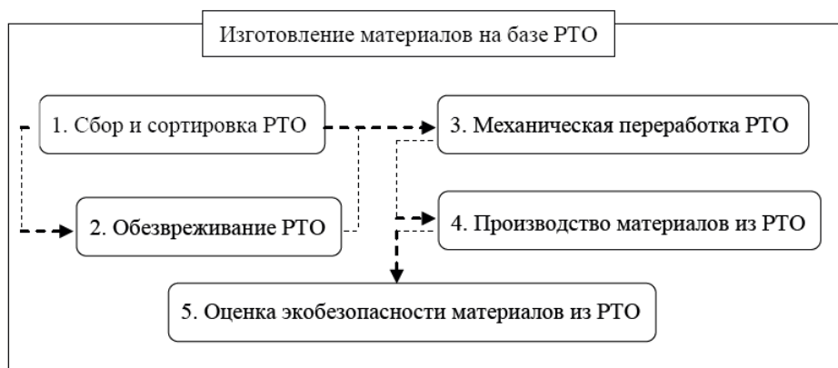
Рис. 2. Последовательная схема изготовления материалов из резиновых отходов
