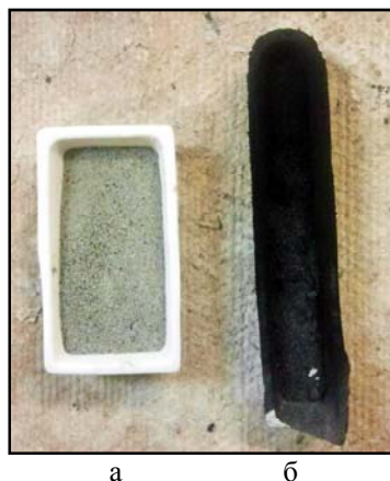
Рис. 3. Внешний вид образцов навески микросфер до (а) и после (б) нанесения пиролитического углерода
