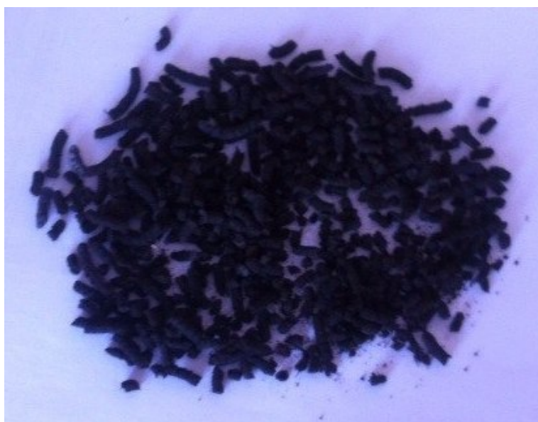
Рис. 1. Гранулированная противогололедная смесь
