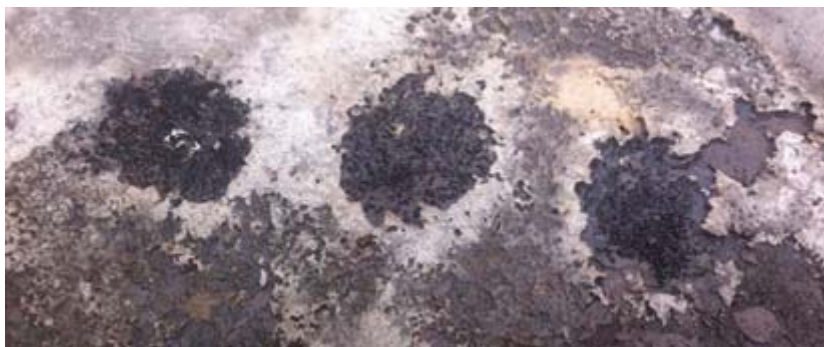
Рис. 2. Смеси через 12 часов (смеси 10,20,30 % содержанием хлорида кальция)
