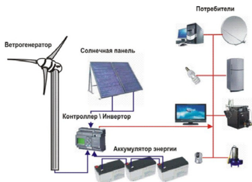
Рис. 1. Комбинированная солнечно-ветровая установка
