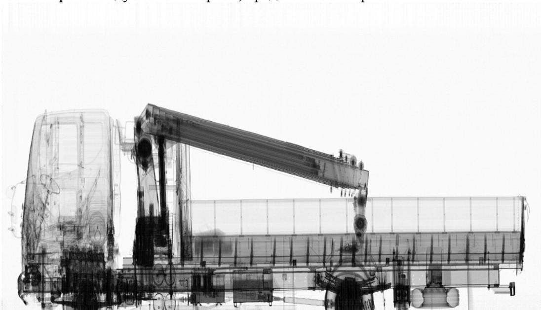
Рис. 8. Изображение, полученное на аппаратуре «Шток- МНК»
