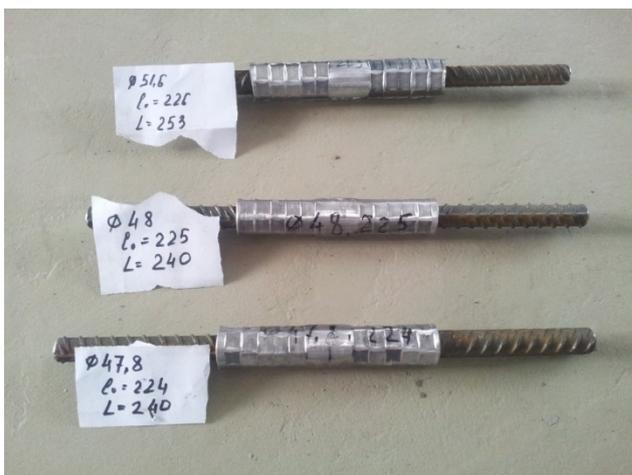
Рис. 1. Общий вид готовых к испытаниям арматурных стержней, соединенных обжатием муфт СО500-28РП
