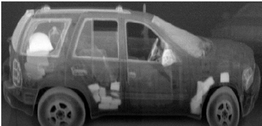
Рис. 10. Изображение, полученное с помощью системы на обратно-рассеянном рентгеновском излучении на аппаратуре «Шток-МНК»
