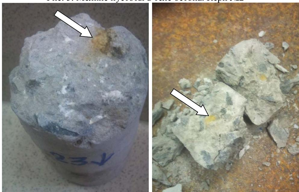
Рис. 6. Мелкие пустоты в теле бетона. Керн №2
