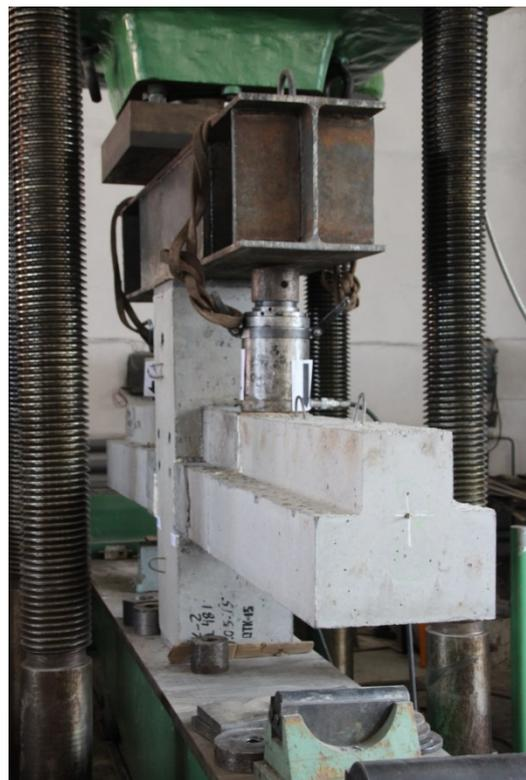
Рис. 12. Общий вид испытания стыка ригель-колонна на статическую нагрузку
