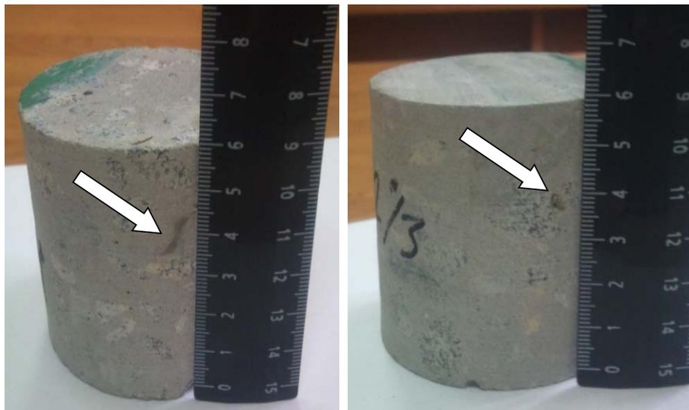
Рис. 5. Мелкие пустоты в теле бетона. Керн №2
