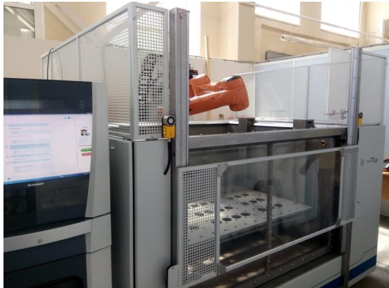
Рис. 1. Комплекс ультразвукового контроля
