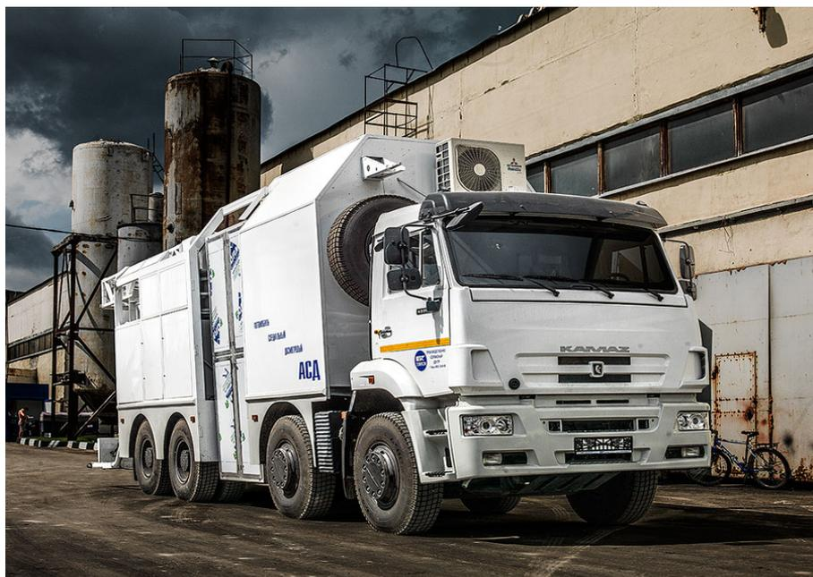
Рис. 6. Внешний вид МДКТС «Шток-МНК» в транспортном положении
