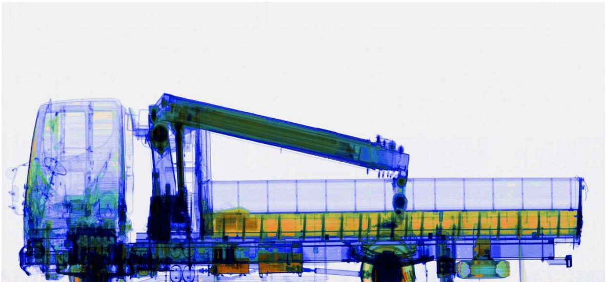
Рис. 9. Изображение, полученное в режиме дуальных энергий на аппаратуре «Шток-МНК»
