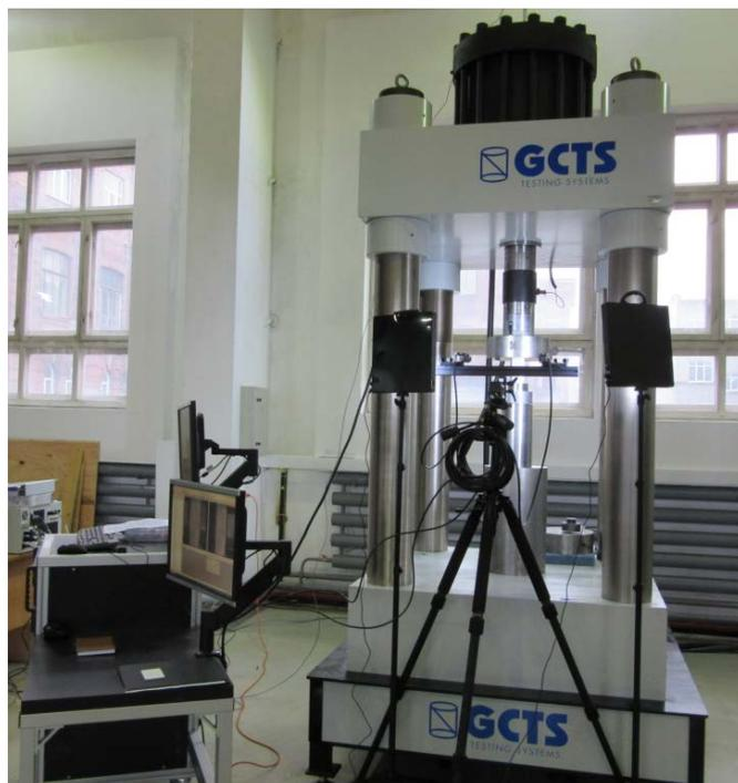
Рис. 4. Общий вид испытательной машины UTM 4500
