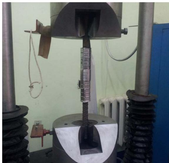
Рис. 2. Общий вид испытания на разрыв в испытательной машине МР-500
