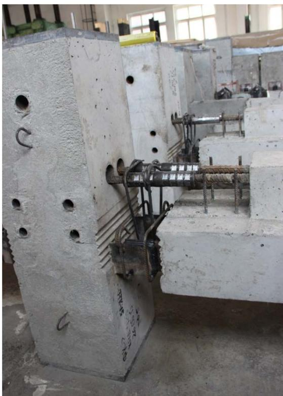
Рис. 11. Общий вид стыка ригель-колонна, собранного с применением обжимных муфт
